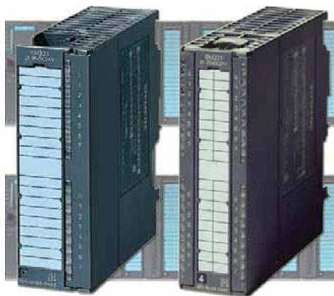
Модули вывода аналоговых сигналов предназначены для цифро-аналогового преобразования внутренних цифровых величин контроллера и формирования выходных аналоговых сигналов. К выходам модулей могут подключаться исполнительные устройства, управляемые унифицированными сигналами силы тока или напряжения.
